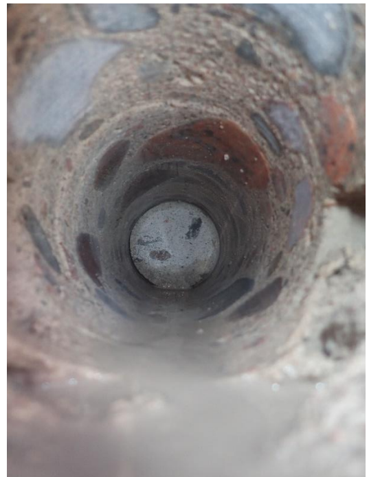
Kuva 1a, b ja c. Esimerkki alimman kerroksen kohdalle tehdystä rakenneavauksesta. Sokkelin luonnonkiviverhouksen yläpuolella yli 300 mm:n poraus ei vielä ulottunut sokkelin lämmöneristeseen saakka.
